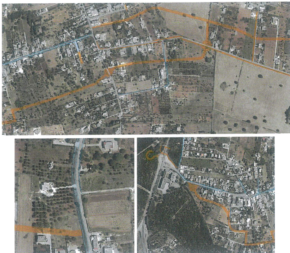
Figura 9 Viabilità di previsione (arancio) e adeguamenti stradali (azzurro) nel CU San Paolo
